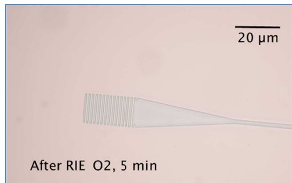
Abb. 10 Medusa-Strukturen nach dem \text{O}_2 -Ätzen Schichtdicke noch 140 nm
