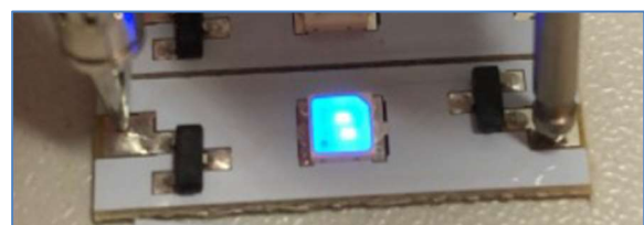
Bild 2 Blaue LED ohne Vergussmasse mit Quantum Dots
