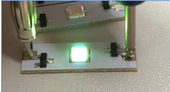
Bild 3 LED mit einer Quantum Dot-haltigen PMMA-Schicht
