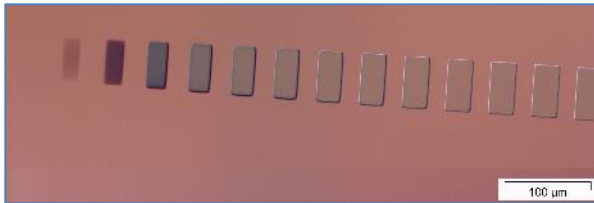
Abb. 6 Dosisstaffel Medusa 82 bei 30 kV Beschleunigungsspannung, Entwickler AR 300-44, 90 Sekunden
