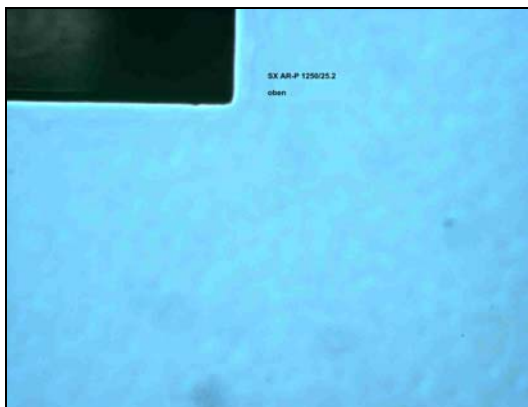
Gute Lackoberfläche bei völliger Bedeckung aller Topologien – Positivresist SX AR-P 1250/25.2
