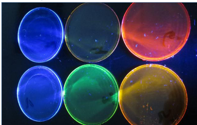
Unterschiedlich fluoreszierende Atlas 46 - Schichten (Bestrahlung mit Schwarzlicht)
