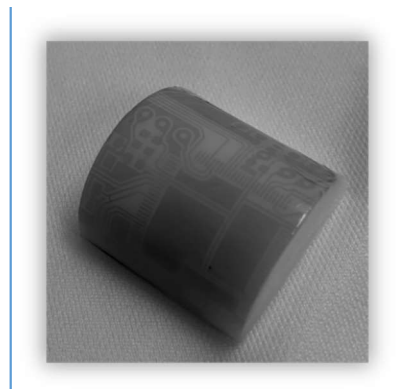
Abb. 7 Das Substrat nach Belichtung und Entwicklung
